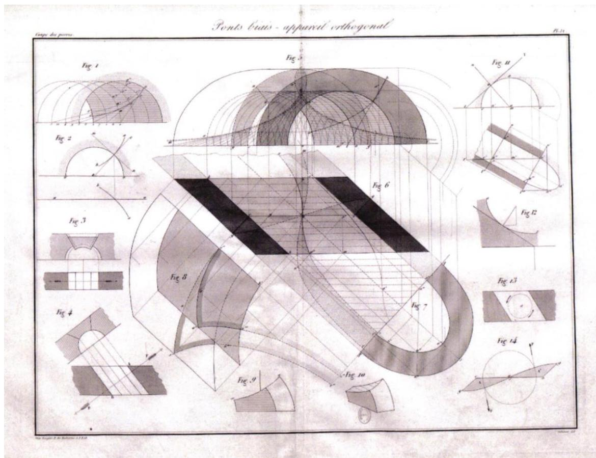
Obr. 12. Joseph Adhémar Pont biais - ortogonální zřízení ([1], tabulka 14)
