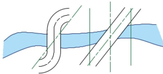
Obr. 13. Šikmé přemostění s naznačením nahrazení kolmým přemostěním
