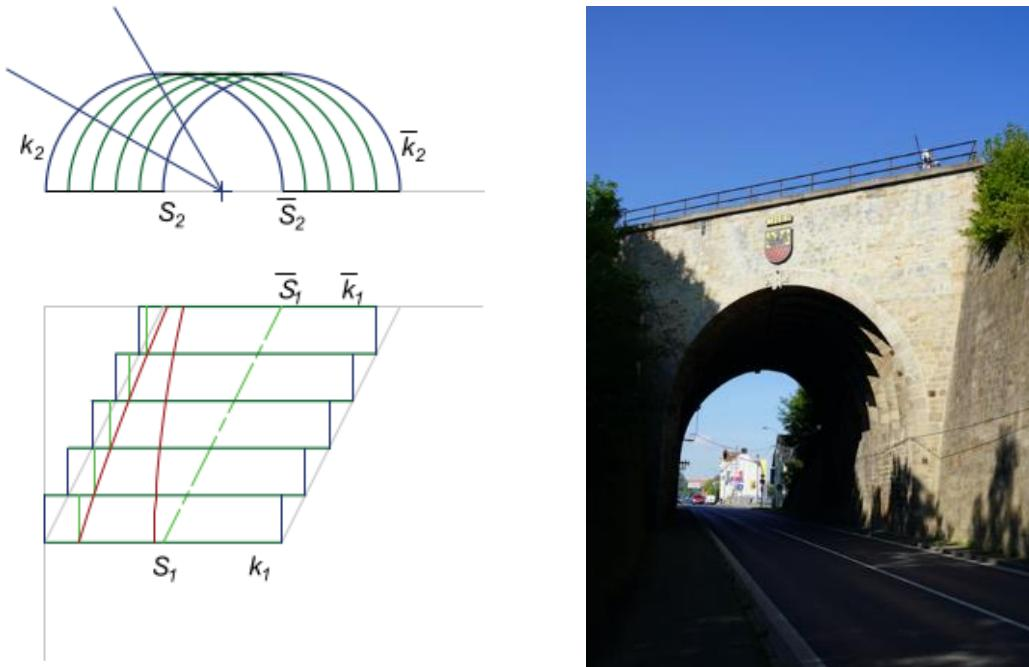
Obr. 10. Zaklenutí šikmého průchodu pomocí zřízení ortogonálního, náčrt řešení a viadukt v Chebu
