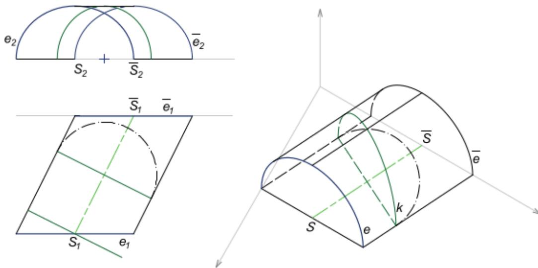
Obr. 3. Šikmým řezem rotační válcové plochy jsou elipsy, kruhový oblouk v čele klenby nemá oporu, tj. v této podobě ji nelze použít v praxi
