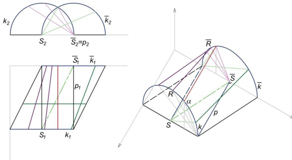
Obr. 7. Řešení šikmého průchodu pomocí dvou zborcených přímkových ploch, s řídicími přímkami procházejícími středy řidicích kruhových oblouků kolmo k rovinám těchto oblouků
