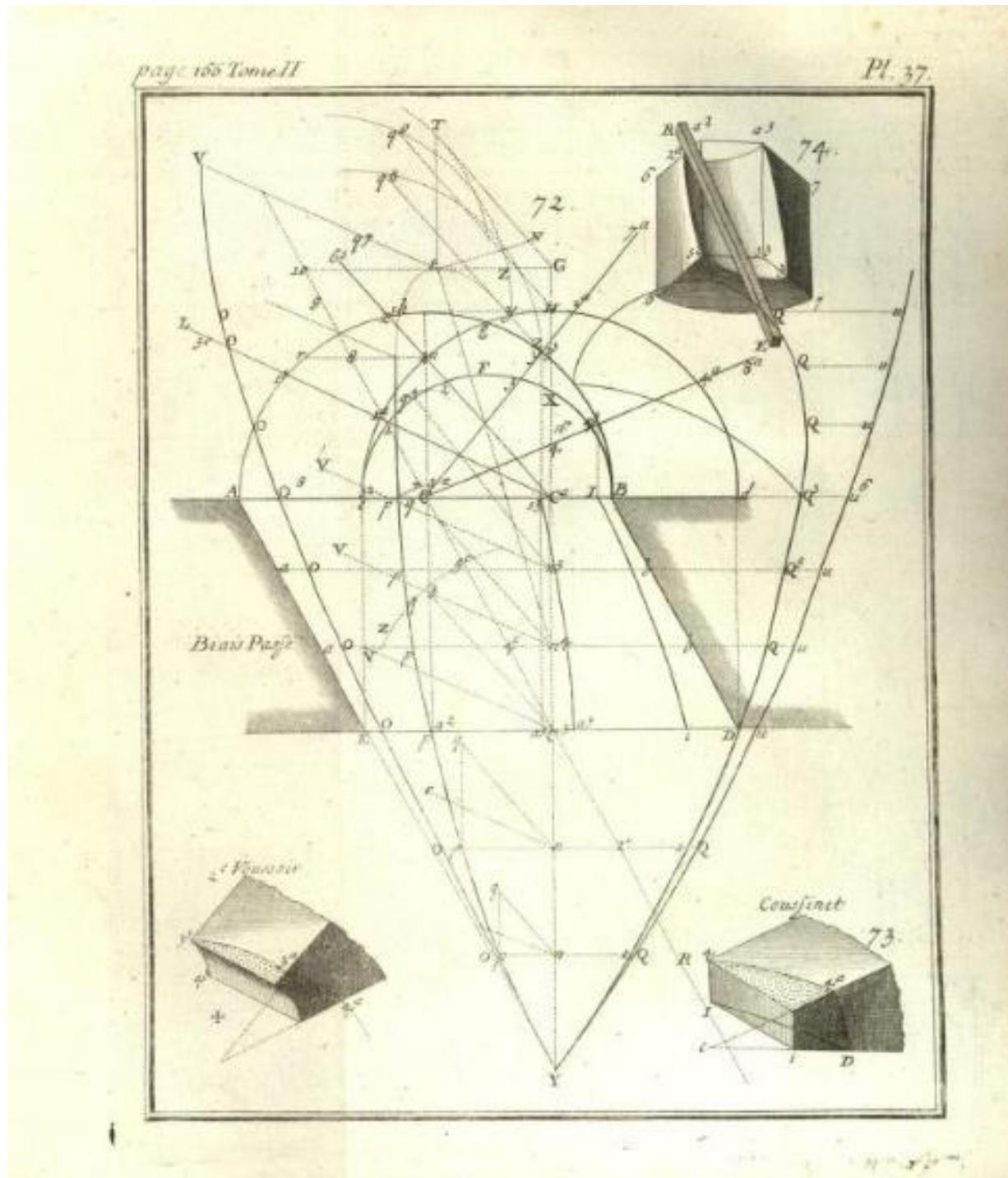
Obr. 9. Freziér - řešení šikmého průchodu ([8], str. 156)
