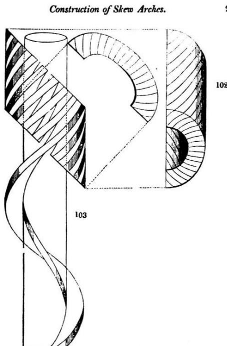
Obr. 14. Šroubová (helicoidální) konstrukce podle Ch. Foxe [7]
